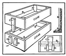
Fig. 2 - Homemade Flask
