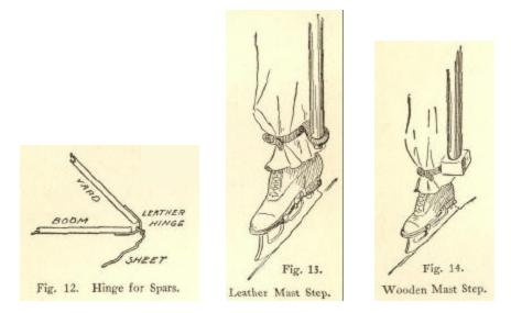
Fig. 12. Hinge for Spars. | Fig. 13. Leather Mast Step. | Fig. 14. Wooden Mast Step.
